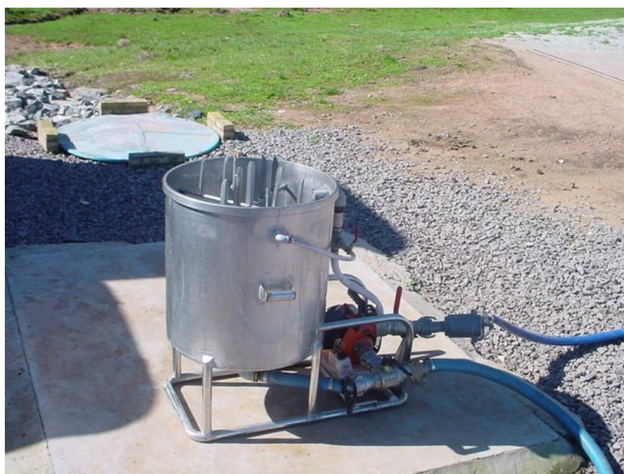
Figura 2 - Sistema de pré-mistura e carregamento
