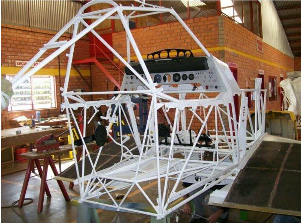
Figura 1 - Estrutura sendo recuperada
