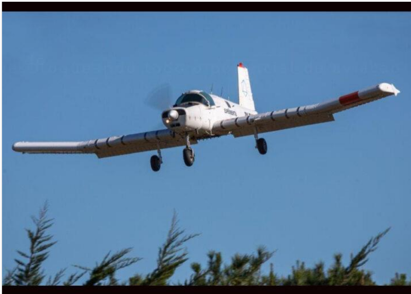
“DRONIZADA”: Testes de campo ocorrem com um aeronave agrícola Fletcher preparada para ser pilotada à distância
