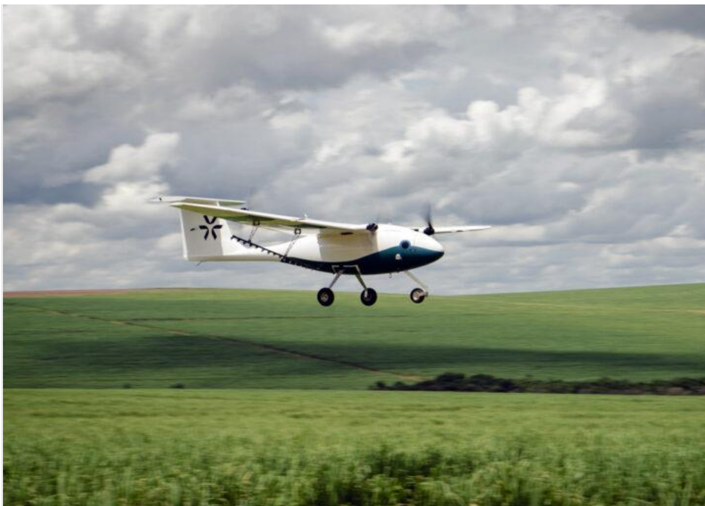
PELICAN: avião autônomo norte-americano não tem a mesma capacidade de uma aeronave convencional, mas já voa nos EUA, Nova Zelândia e Costa Rica (onde opera inclusive à noite)
