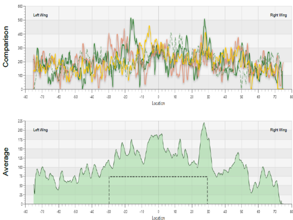
Figura 2. Esquema de saída do software mostrando a faixa de deposição efetiva e a área total de deposição.
