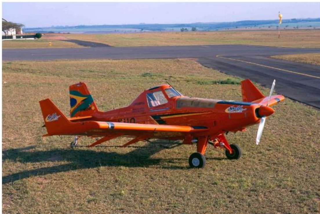
Modelo do EMB 202 Ipanema, da Embraer, primeiro avião agrícola movido a álcool, em campo de testes de São José dos Campos (SP) - Embraer/Divulgação
