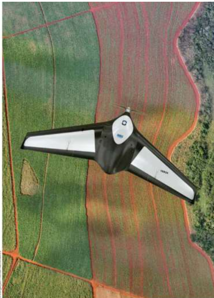
Produzido pela Horus Aeronaves, o Verok é um drone multisensor com autonomia de voo de até duas horas
